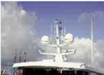
Radar, Satelliten-Antennen etc. auf dem elektrisch zu klappenden Aluminiummast.
