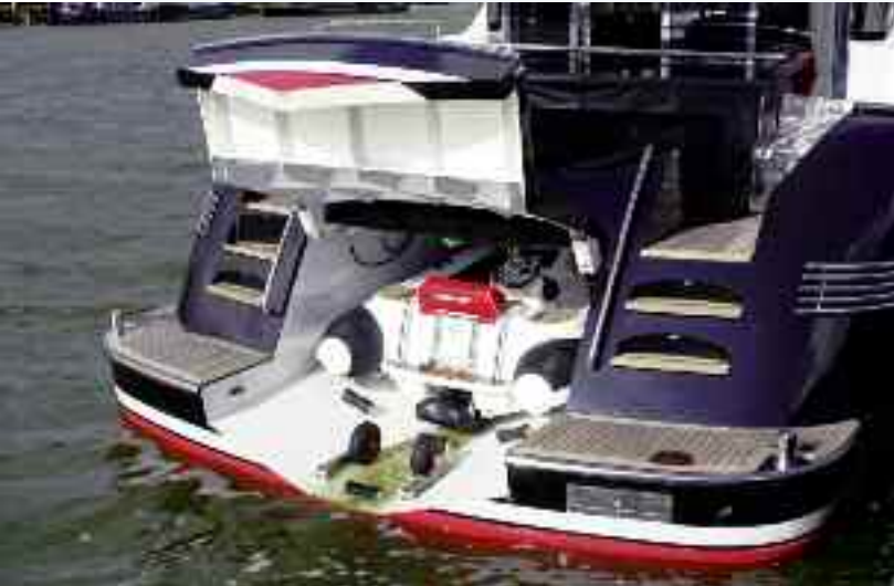
Achtersteven mit Innenleben: Jet-angetriebenes Williams-RIB in der Heckgarage mit elektrohydraulischer Luke, Länge 3,85 m.
